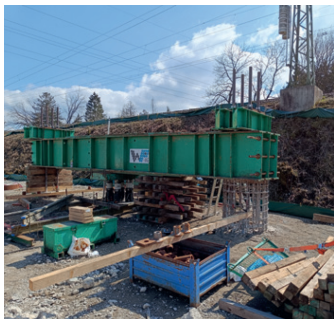
Versuchsaufbau der Pfahlprobelastung
