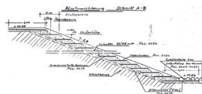
Querprofil mit Erosionsschutzbahnen aus dem Archiv der Emschergenossenschaft
