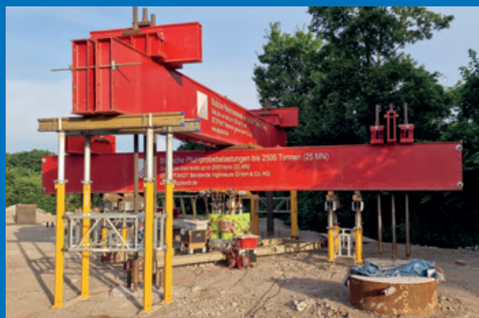
Vertikale Pfahlprobelastung in Duisburg
