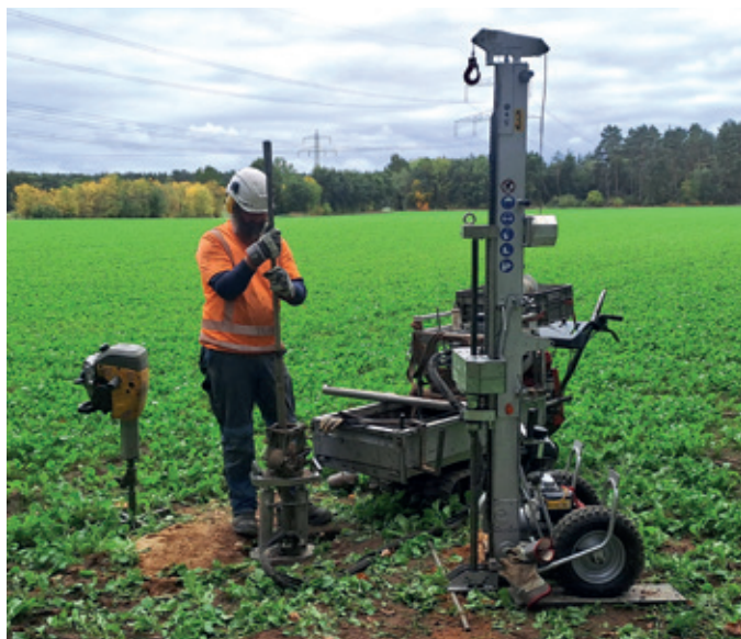
Kleinrammbohrung zur Erkundung von Schutzgerüststandorten
