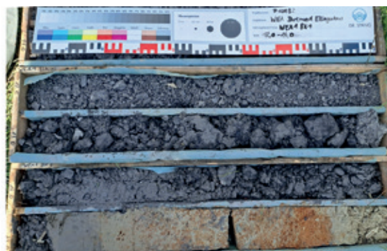
Bohrprofil sowie Kernkiste des Übergangs von Haldenmaterial zu Auelehm
