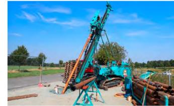
Bohrgerät fertig eingerichtet für Schrägbohrung BK VF-4c
