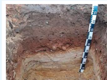
Bodenprofil des besonderen Bodentyps Fuchserde im Schurf
