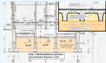
Querschnitt mit Darstellung der zu verfüllenden Kellerräume und Detail der Rippendecke
